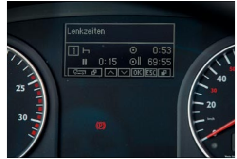
Im Display sind die Lenk- und Ruhezeiten minutengenau zu erkennen.
