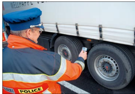
Die Umgebungstemperatur der Bremsen verrät den technischen Zustand des Lkw.
