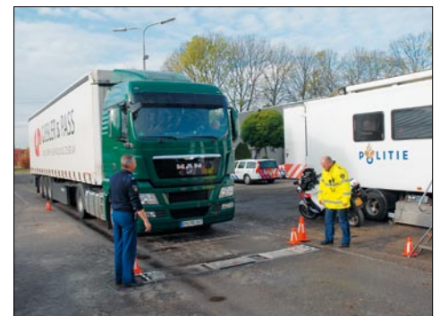
Bei allen zu kontrollierenden Lastzügen wird zuerst die Achslast ermittelt.
