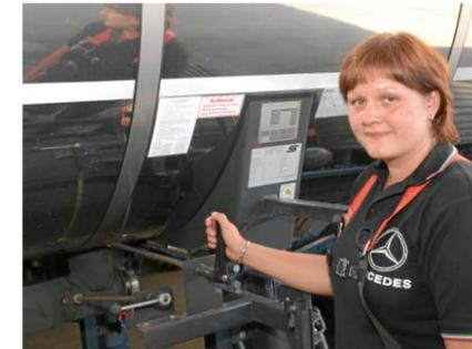
Über den seitlichen Hebel und das Bodenventil steuert sie die Kammerfüllung.
