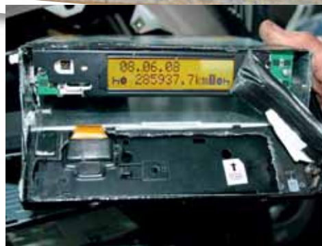
... bei genauer Kontrolle der Polizei steckt ein zusätzlicher analoger Tacho dahinter.
