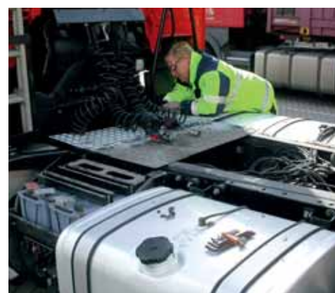
Bei Manipulationsverdacht muss der Sattel weg, um an das Getriebe zu gelangen.
