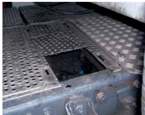
Die Klappe im Blech über dem Getriebe erleichtert die Magnetmanipulation.
