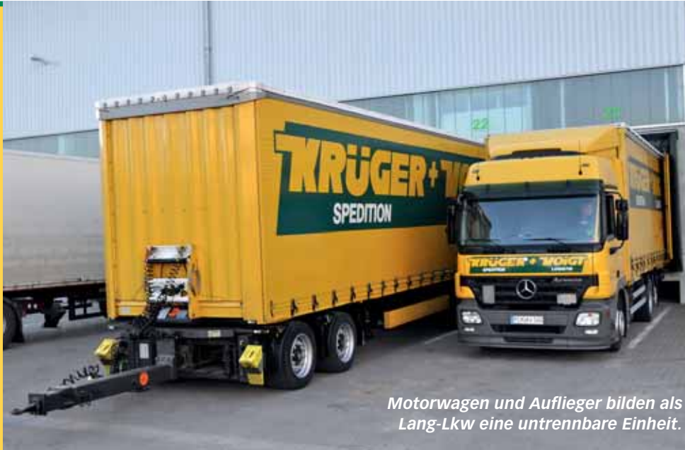
Über das Fangmaul wird der zweiachsige Dolly mit dem Lkw verbunden.
