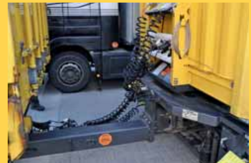
Über das Fangmaul wird der zweiachsige Dolly mit dem Lkw verbunden.
