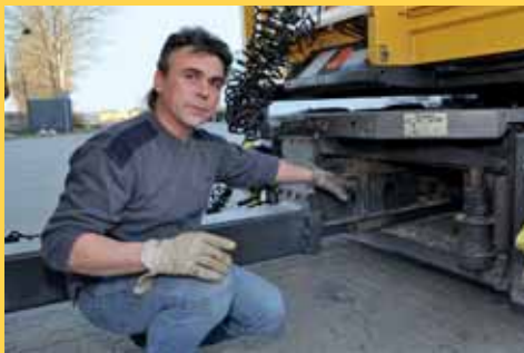
Sobald Sempf den Rückwärtsgang einlegt, werden die Dolly-Achsen arretiert.
