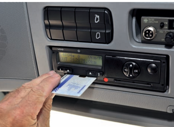
Neuere Fahrerkarten mit der Kennziffer 216 speichern 36 Kilobyte.
