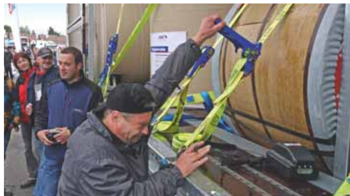
Bei der Ladungssicherung geht nichts über reale Bedingungen, um das Niederzurren zu üben.
